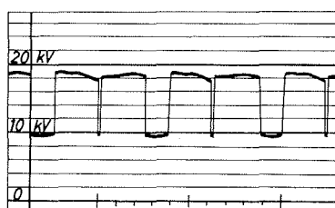
Phasenfehler und kurzgeschlossene Minusdiode
