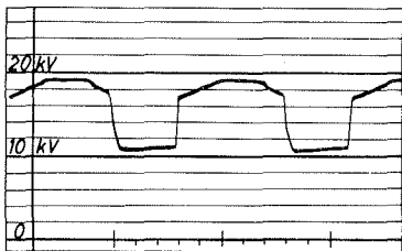
Kurzschluß einer Erregerdiode
