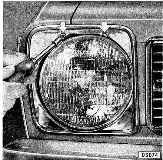
Vier Blechgewindeschrauben für Scheinwerferbefestigung abschrauben.
